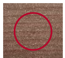
natürlicher Fasereinschluss nach mechanischer Behandlung
